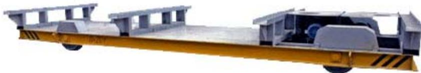
**Тележка представляет собой** сварную плоскую раму из швеллера. На раме установлены 4 одноробордных колеса, на двух из которых установлены зубчатые венцы. К раме приварены поперечные балки, на которые укладываются плоские изделия или монтируются специальные подставки.
