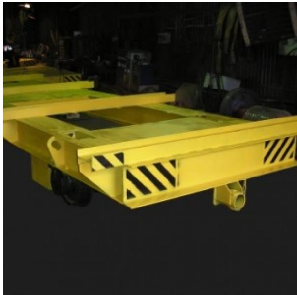
Тележка грузовая предназначена для перемещения различных грузов до 63 т по внутренним железнодорожным путям как внутри помещения, так и для вывоза грузов за пределы помещения.
